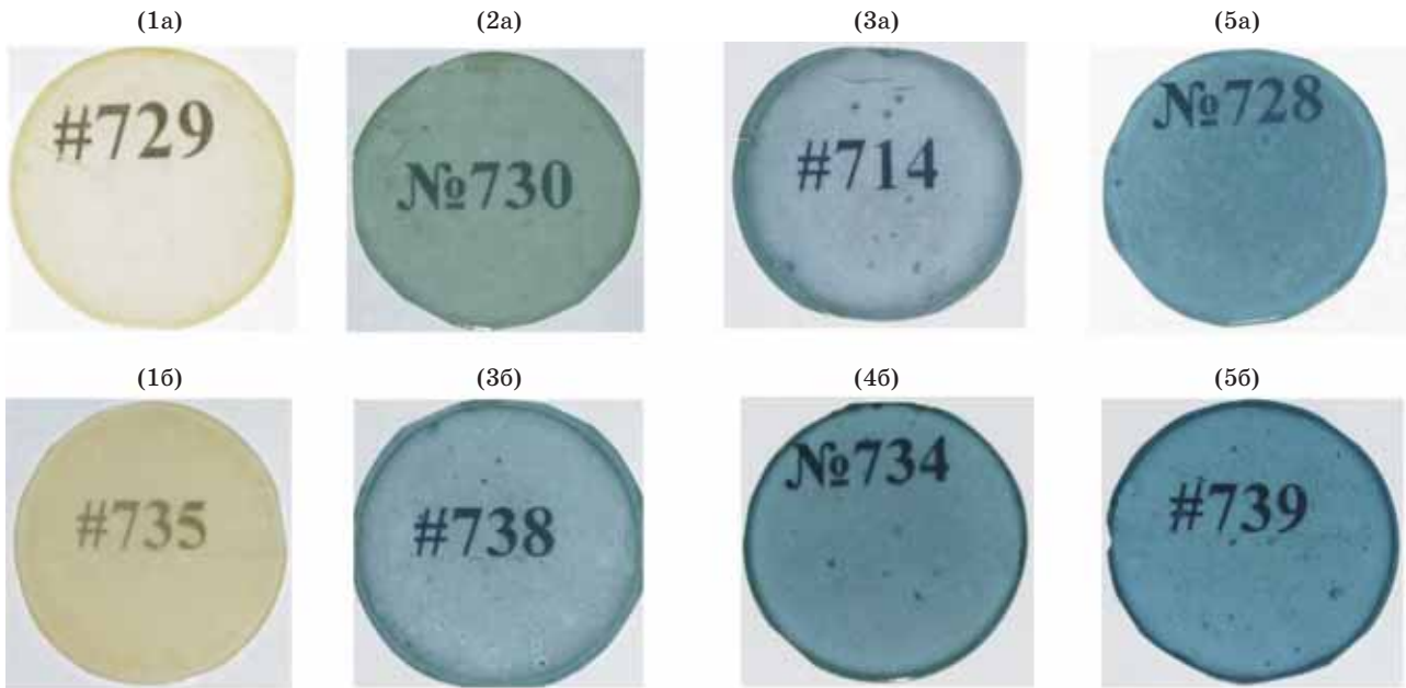
Рис. 3. Характерные фотографии образцов ZnO и ZnO:Ga, изготовленных из порошков по ТУ-6-09-2175-77 (1а, 2а, 3а, 5а) и Sigma-Aldrich (1б, 3б, 4б, 5б). Номера фотографий соответствуют номерам образцов, приведенных в табл. 1.
