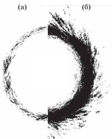
Рис. 4. Визуализация наложения нескольких распределений интенсивности, полученных при смещении плоскости наблюдения на 200 мкм через 50 мкм при различных уровнях отсечения визуализации U_l : а — 200, б — 50
