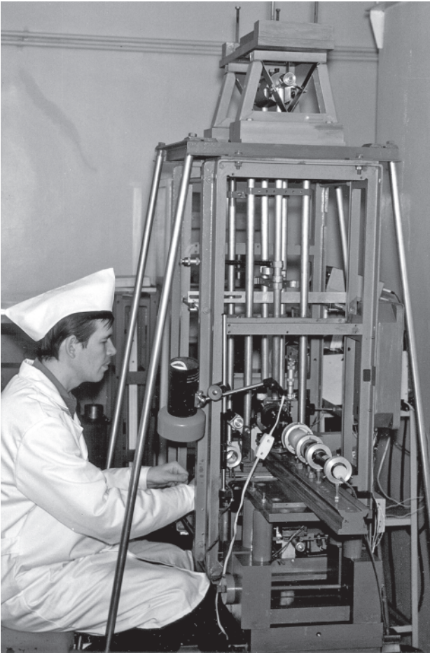
Рис. 1. Внешний вид макета делительной машины маятникового типа.
