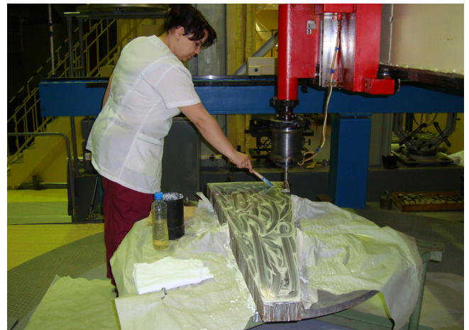
Рис. 6. Финишная доводка матрицы.
