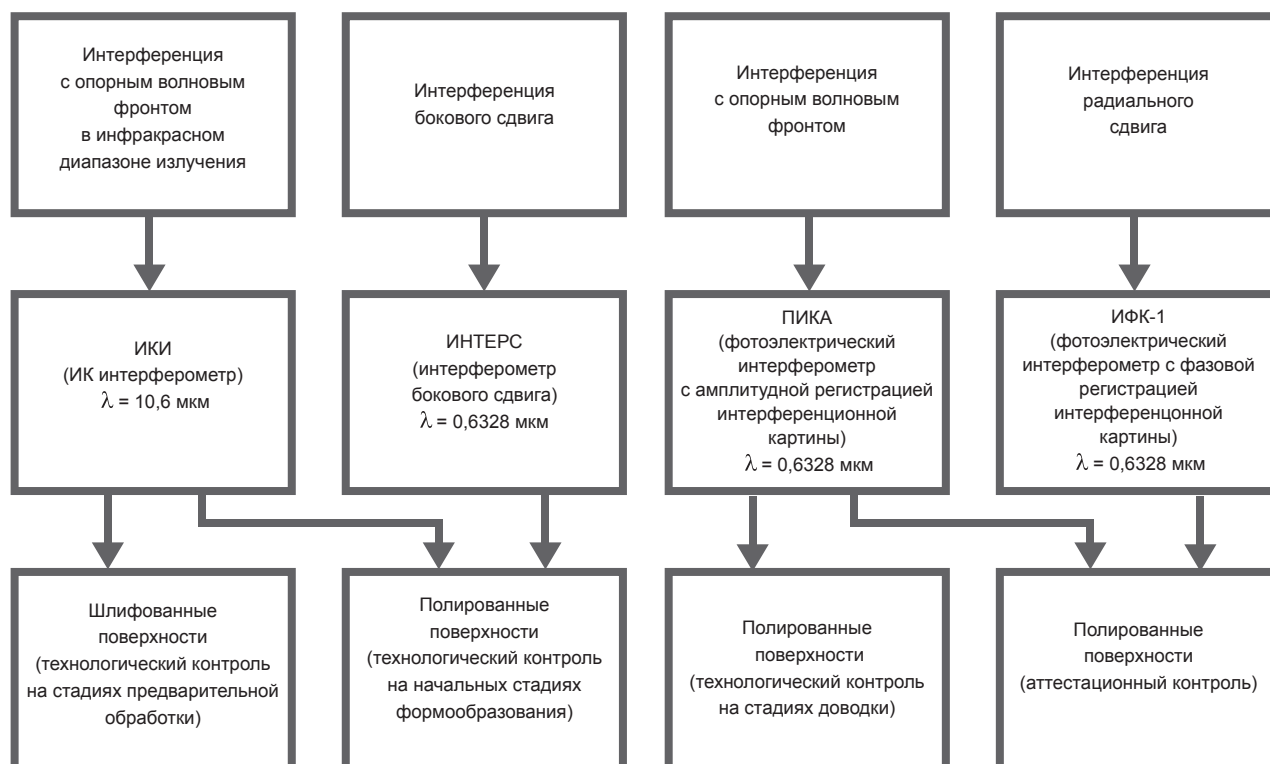
Рис. 3. Обеспечение интерферометрическими средствами контроля технологических стадий формообразования.
