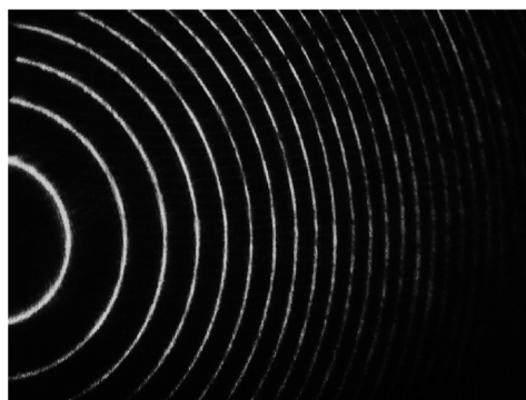
Рис. 3. Фотография (а) поперечного распределения энергии излучения в дальней зоне и интерферограмма (б) излучения исполнительного лазера.
