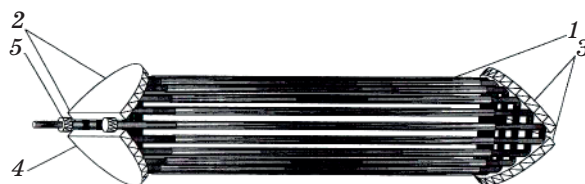
Рис. 1. Оптическая схема излучателей многоканальных волноводных \text{CO}_2 -лазеров диффузионного охлаждения. 1 – газоразрядные трубки, 2, 3 – поворотные зеркала, 4 – заднее зеркало резонатора, 5 – выходное зеркало резонатора.
