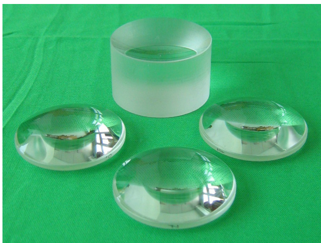
Рис. 1. Мастер-матрица и три реплицированные асферические линзы
