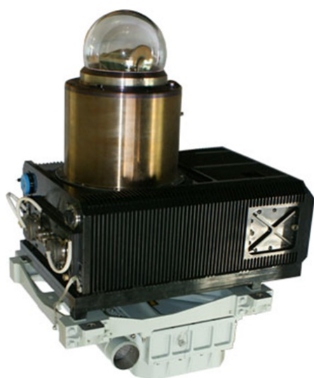
Рис. 2. Лазерная система ОЭП ПЗРК с ИК ГСН, входящая в бортовой многофункциональный комплекс обороны ЛА «Президент-С» [1].
