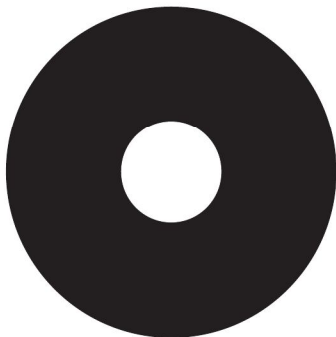
Рис. 2. Фото поперечного сечения одного из вытянутых капилляров: внешний диаметр капилляра D_K = 1000 мкм, больший внутренний диаметр d_{KB} = 207 мкм, меньший внутренний диаметр d_{KM} = 195 мкм, относительный диаметр отверстия \xi_K = 0.206 , эллиптичность отверстия \varepsilon_K = 1,12 .
