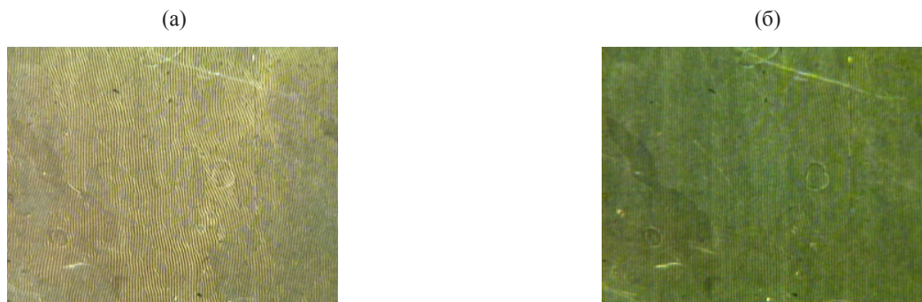
Рис. 6. Вид флексоэлектрических доменов в поляризованном свете в слегка расскращенных николях. а – U_c = 30 \text{ В} , U_{ac} = 0 \text{ В} (видно большинство дефектов). б – U_c = 30 \text{ В} , U_{ac} = 25 \text{ В}_{rms} (видны хорошо ориентированные флексоэлектрические домены). Длинная сторона снимка соответствует 1057 мкм, температура комнатная.
