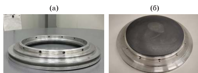
Рис. 2. Центрировка асферической поверхности линзы в оправе. Технологическая оправа (а) с вклеенной в нее линзой (б)
