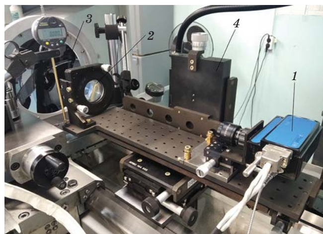
Рис. 3. Установка для центрировки асферической поверхности линзы в оправе на базе прецизионного токарного станка. 1 — интерферометр Fisba \mu Phase, 2 — голограммный компенсатор, 3 — линза с асферической поверхностью в оправе, 4 — пятикоординатный стол
