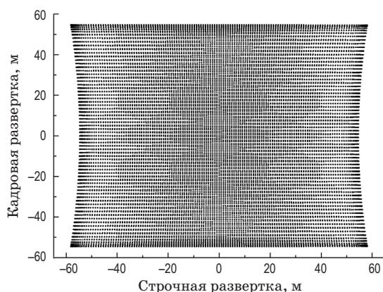
Рис. 4. Результаты расчета формы зоны сканирования в пространстве предметов для схемы с зеркалом в кардановом подвесе. Диапазон сканирования \pm 20^\circ .
