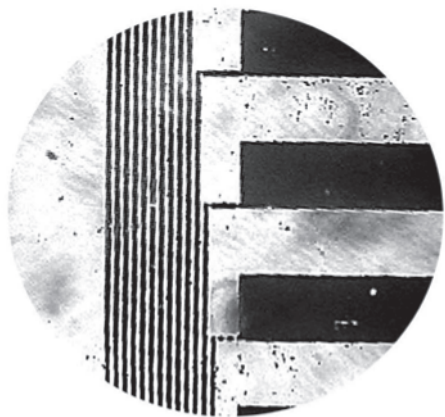
Рис. 3. Хромовые ламели шириной 1,3 мкм на стеклянной подложке созданные двухмасочным методом по технологии проекционной голографической фотолитографии.
