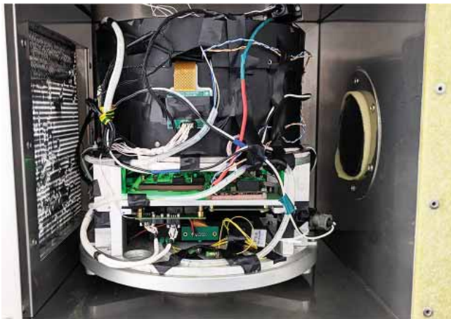
Рис. 4. Расположение ВОГ на одноосевом стенде в термокамере
