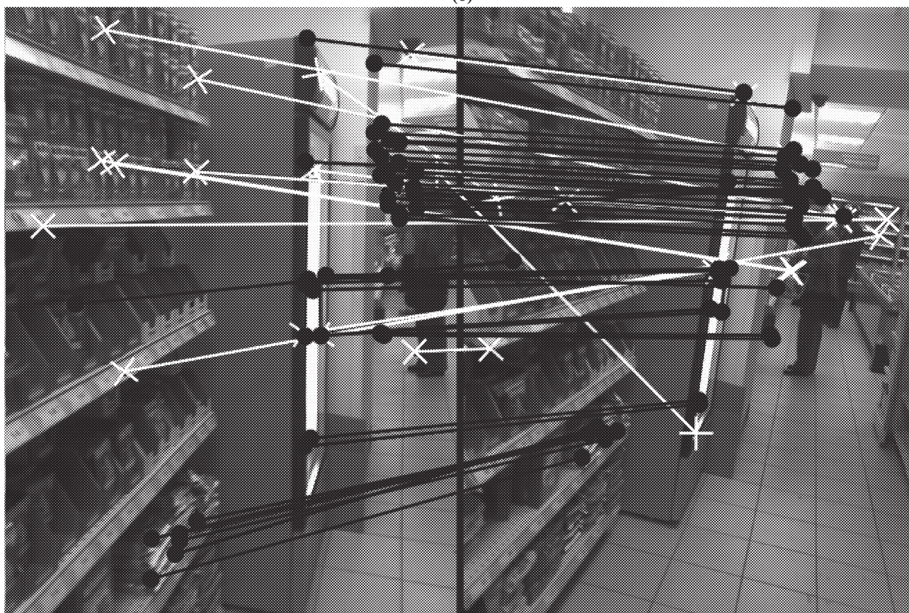
Рис. 3. Результаты сопоставления пары цветных изображений оригинальным методом SURF (a) и его модификацией на основе цветового тензора (б). Белыми линиями отмечены ложные соответствия.
