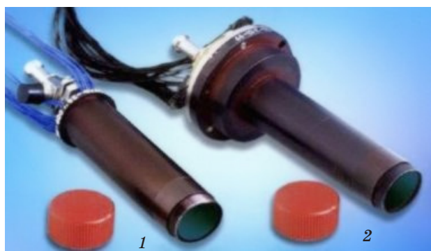
Рис. 5. Фотографии двух ФР (1 – ФЧЭ в формате 2 \times 16 , 2 – ФЧЭ в формате 2 \times 32 ) для тепловизионной техники, работающей в диапазоне температур окружающей среды от -60 до +60 °С.
