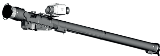
Рис. 1. Прицел для обнаружения воздушных целей.
