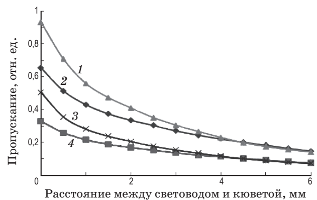
Рис. 4. Коэффициент пропускания оптической системы ВОПД с различными диаметрами d сердцевины световодов и D кюветы. 1 – d = 400 мкм, D = 1,3 мм, 2 – d = 400 мкм, D = 2 мм, 3 – d = 200 мкм, D = 1,3 мм, 4 – d = 200 мкм, D = 2 мм.
