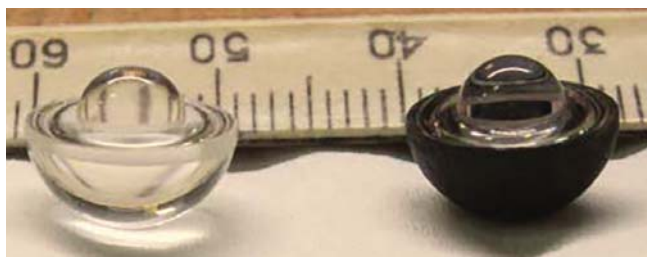
Рис. 3. Фотография СЭ с угловым полем 176^\circ без покрытия (слева) и с защитным покрытием (справа) Fig. 3. Photograph of retroreflective elements with a field of view of 176^\circ (left) without coating and (right) with protective coating
