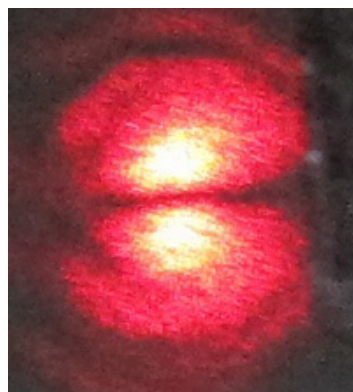
Рис. 5. Типичное распределение интенсивности луча по площади на экране нулевого эллипсометра в положении минимальной остаточной интенсивности при исследовании пленок с резко выраженной клиновидностью.
