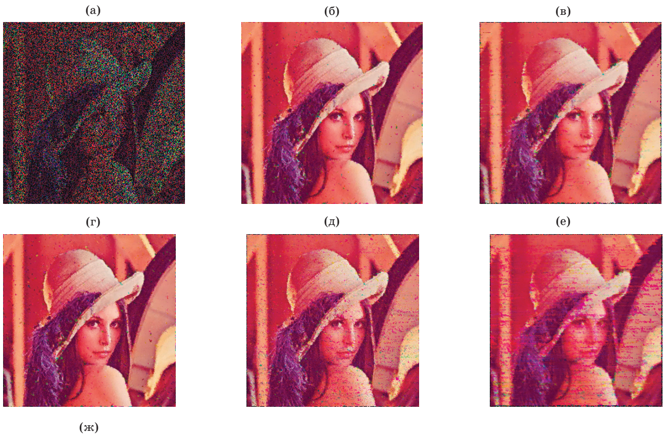
Рис. 2. Результаты реконструкции цветного изображения. а – искаженное АП изображение, б – обработка с помощью алгоритма 1 при МФ по всем элементам апертуры, в – обработка с помощью алгоритма 1 при МФ по выборке неискаженных элементов апертуры, г – обработка с помощью алгоритма 2 при МФ по всем элементам апертуры, д – обработка с помощью алгоритма 2 при МФ по выборке неискаженных элементов апертуры, е – итерационная МФ по всем элементам апертуры [10], ж – итерационная МФ по выборке неискаженных элементов апертуры.
