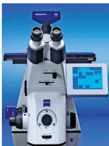
Рис. 10. Управление моторизованной системой микроскопа с помощью ЖК-экрана, закрепленного на штативе ( Carl Zeiss , Германия).
