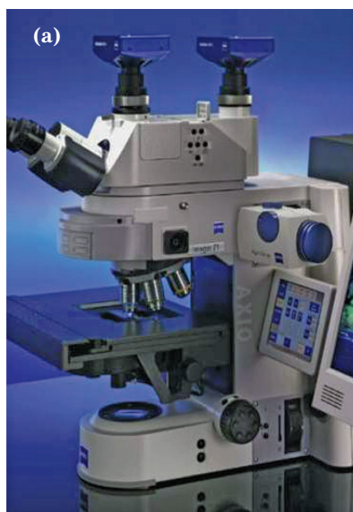
Рис. 13. Система ApoTome : а – микроскоп с системой ApoTome ; б – схема работы устройства ApoTome ; в – принцип получения оптических срезов.
