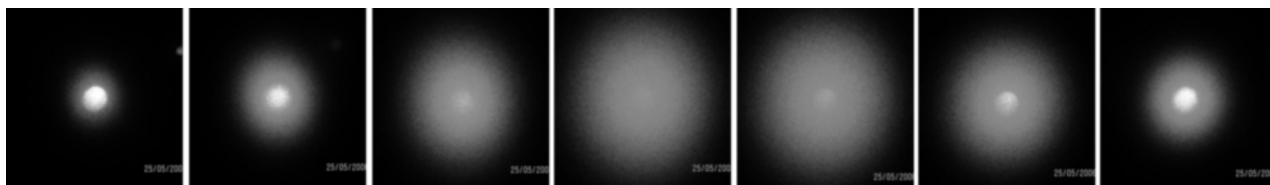
Рис. 3. Картины дифракционных полей, создаваемых голографическими диффузорами, для разных экспозиций фотопластинок когерентным светом.
