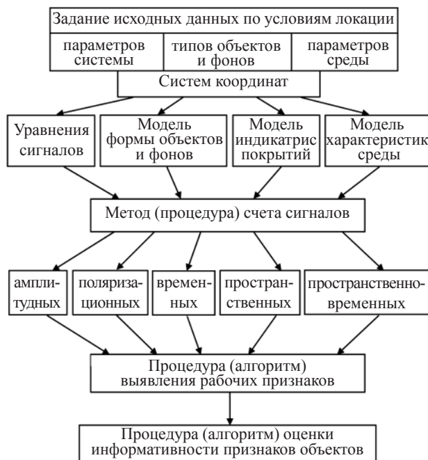
Рис. 1. Обобщенная структурная схема математического имитационного моделирования сигналов и оценки информативности содержащихся в них признаков объектов.
