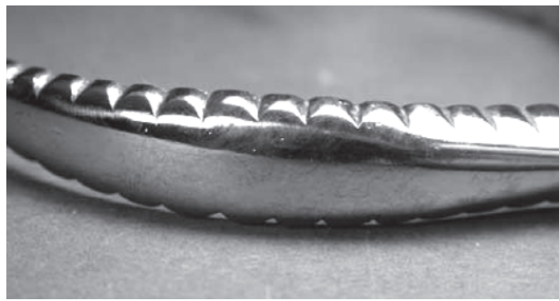
Рис. 5. Щипчики после реставрации с помощью лазерной очистки.
