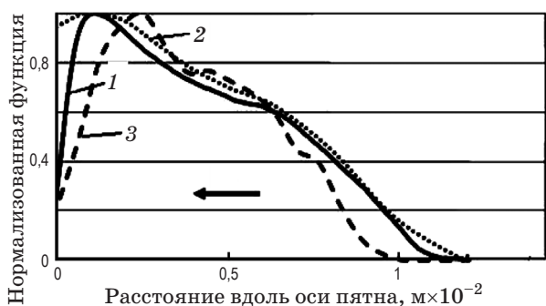
Рис. 10. Сопоставление профиля расчетной скорости уноса материала с экспериментальной и с экспериментальным распределением давления. 1 – экспериментальная функция уноса материала, 2 – расчетная сила, действующая на частицу, 3 – экспериментальное давление.
