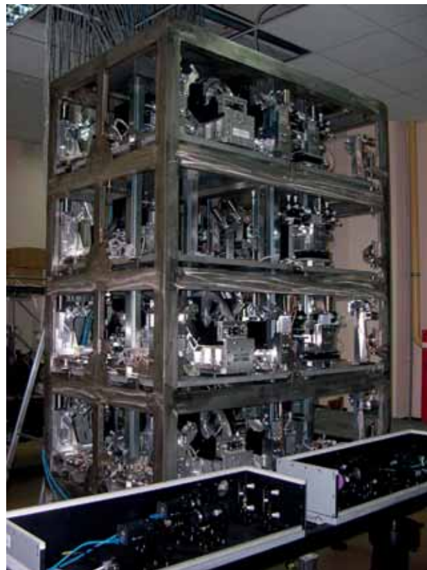
Рис. 6. Башня ТПФ с элементами САЮ. На переднем плане два датчика силового усилителя.
