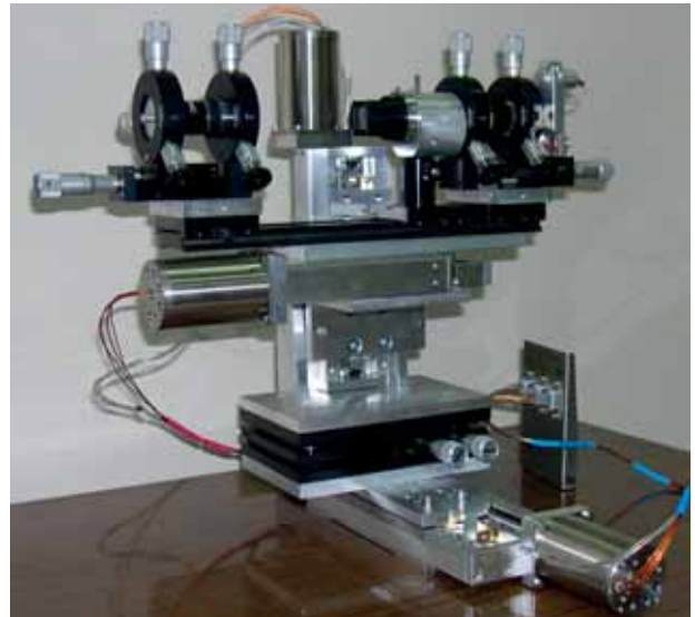
Рис. 5. Вбрасываемый настроечный источник второй гармоники.
