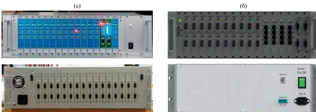
Рис. 8. Субблок для контроллеров шаговых двигателей и световых маркеров (а) и блок ввода/вывода универсальный (б).
