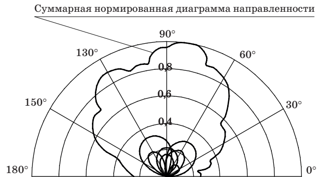
Рис. 3. Пример расчёта суммарной нормированной диаграммы направленности имитатора, состоящего из семи излучателей.
