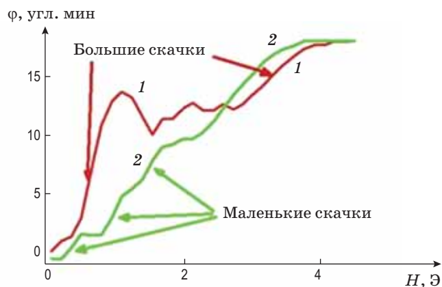
Рис. 7. Скачки в поляризационных откликах \text{FeVO}_3 . Кривая 1 — большие скачки, кривая 2 — маленькие скачки
