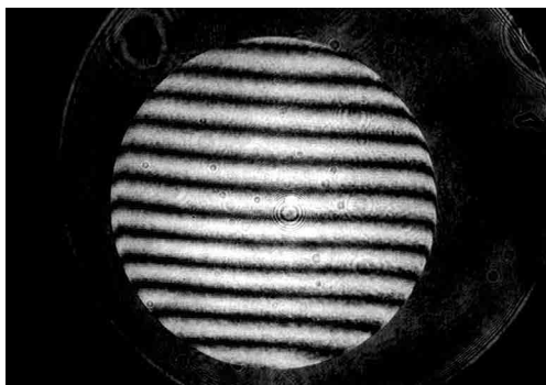
Рис. 9. Интерференграмма внеосевого параболического зеркала с диаметром 200 мм.
