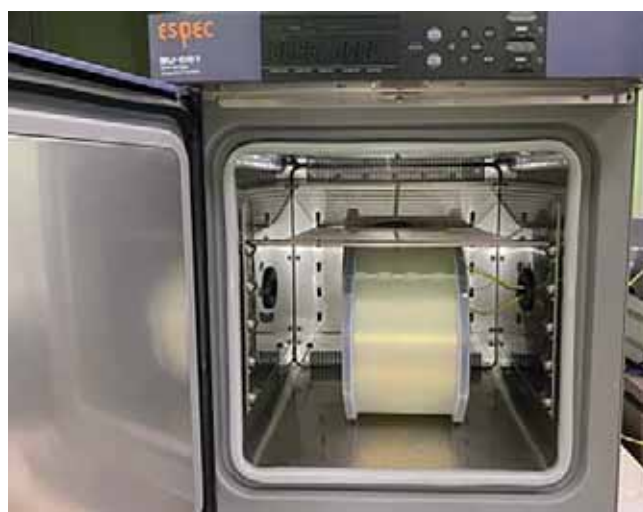
Рис. 3. Внешний вид катушки оптического волокна, помещённой в термокамеру
