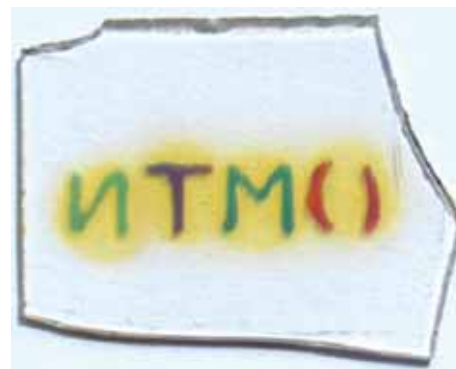
Рис. 2. Пример селективного окрашивания образца МХ стекла, синтезированного в Университете ИТМО, по технологии, разработанной в ГОИ им. С.И. Вавилова [11]
