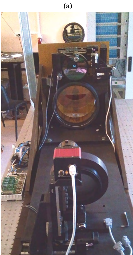
Рис. 1. Вид датчика центра мишенной камеры (ДЦМК): корпус 1, узел объектива 2, зеркало 3, фотоприёмное устройство 4, светоделитель 5, транслятор 6, платформа 7.
