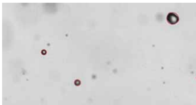
Рис. 6. Пример обработки кадра с детектированием капель в воздушном потоке над водной поверхностью на ВВТСБ. Размер изображения 19,6×11 мм
