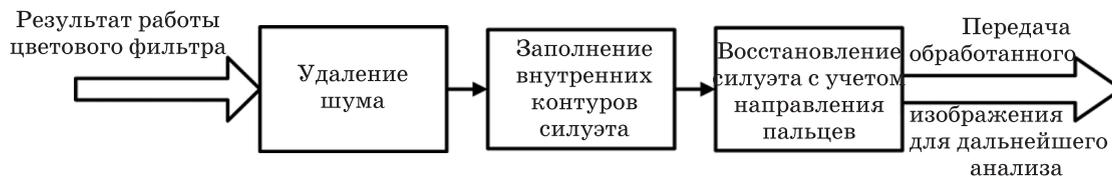
Рис. 2. Общая схема предлагаемого алгоритма обработки бинарных изображений.
