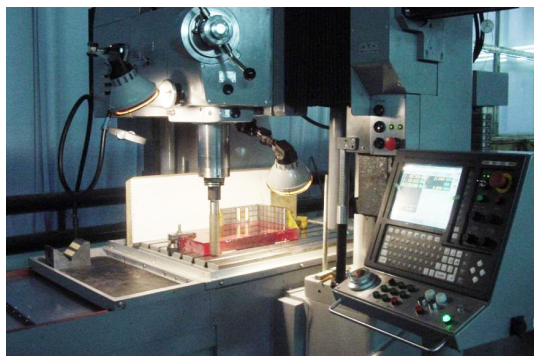
Рис. 3. Процесс обработки боковой грани заготовки ДАЭ на станке 2Е470 и обрабатывающем центре VF-5/40.
