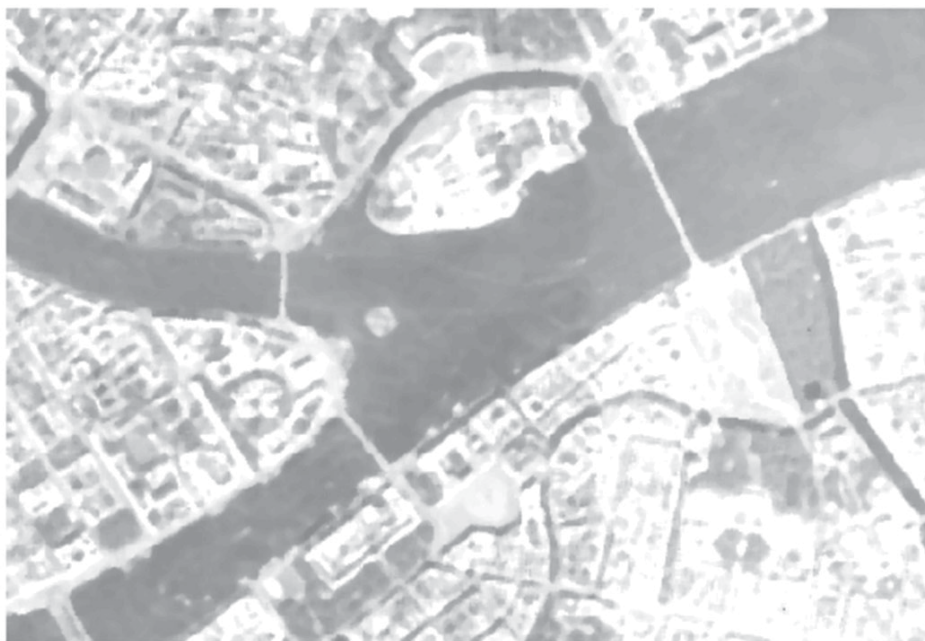
Рис. 8. Результат фильтрации x_{i,j} известной медианной процедурой обработки.
