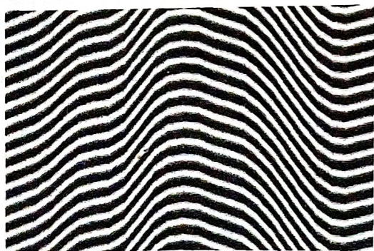
Рис. 2. Интерферограммы бокового сдвига для эллиптического цилиндра на промежуточной стадии обработки с продольной и поперечной ориентациями полос.
