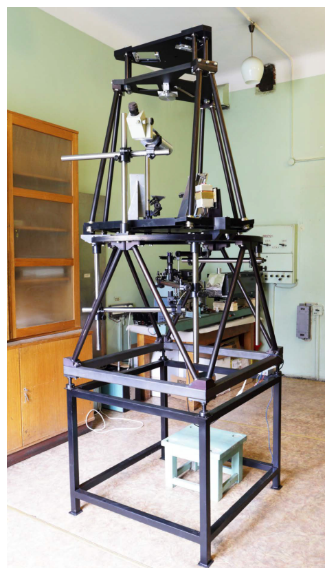
Рис. 3. Имитатор ОМБ БС, установленный на юстировочном стенде.
