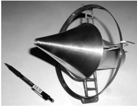
Рис. 9. Полетная модель АКЛРД.
