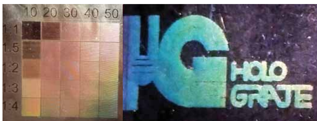
Рис. 11. Дифракционные элементы на основе ступенчатых структур при просмотре их в нулевом порядке дифракции. На левом рисунке по горизонтали — частота несущей решетки, \text{мм}^{-1} , по вертикали — скважность
