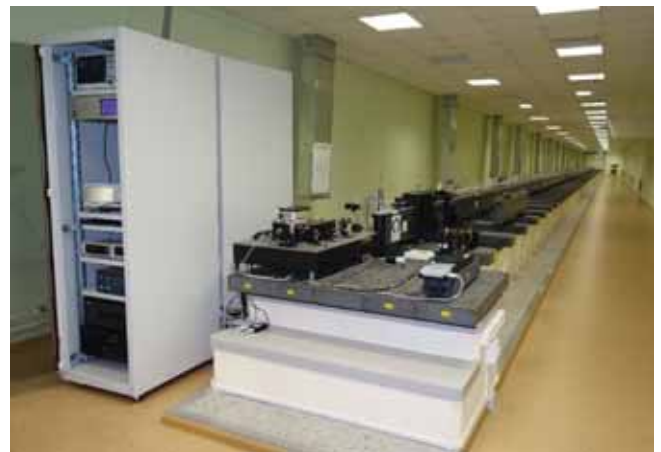
Рис. 2. Эталонный измерительный комплекс длины до 60 м на основе фемтосекундного лазера и измерительного базиса ГЭТ 199
