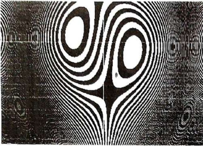
Рис. 2. Преобразование интерферограмм при малом угле поворота бифокальной линзы вокруг оси y . Исходные интерферограммы соответствуют горизонтальным рядам 1 и 5 (см. таблицу) для рис. 2а и рис. 2б соответственно. Интерферограммы синтезированы на ЭВМ.
