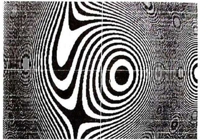
Рис. 2. Преобразование интерферограмм при малом угле поворота бифокальной линзы вокруг оси y . Исходные интерферограммы соответствуют горизонтальным рядам 1 и 5 (см. таблицу) для рис. 2а и рис. 2б соответственно. Интерферограммы синтезированы на ЭВМ.
