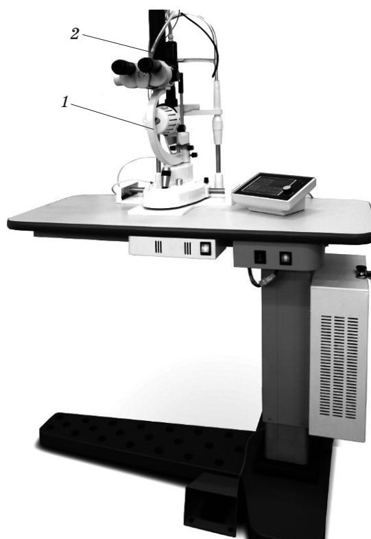
Рис. 1. Офтальмологический лечебно-диагностический комплекс. 1 – лампа щелевая, 2 – мультиволновый сканирующий лазерный излучатель.
