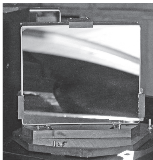
Рис. 5. Широкоапертурная вогнутая голограммная решетка.
