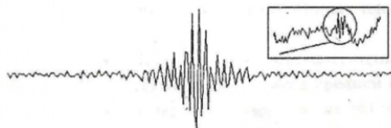
Рис. 1. Интерферограмма ДОПИ, содержащая фазовую ошибку. На выделенном участке показана наводка от замкнутой системы охлаждения (масштаб 5:1).
