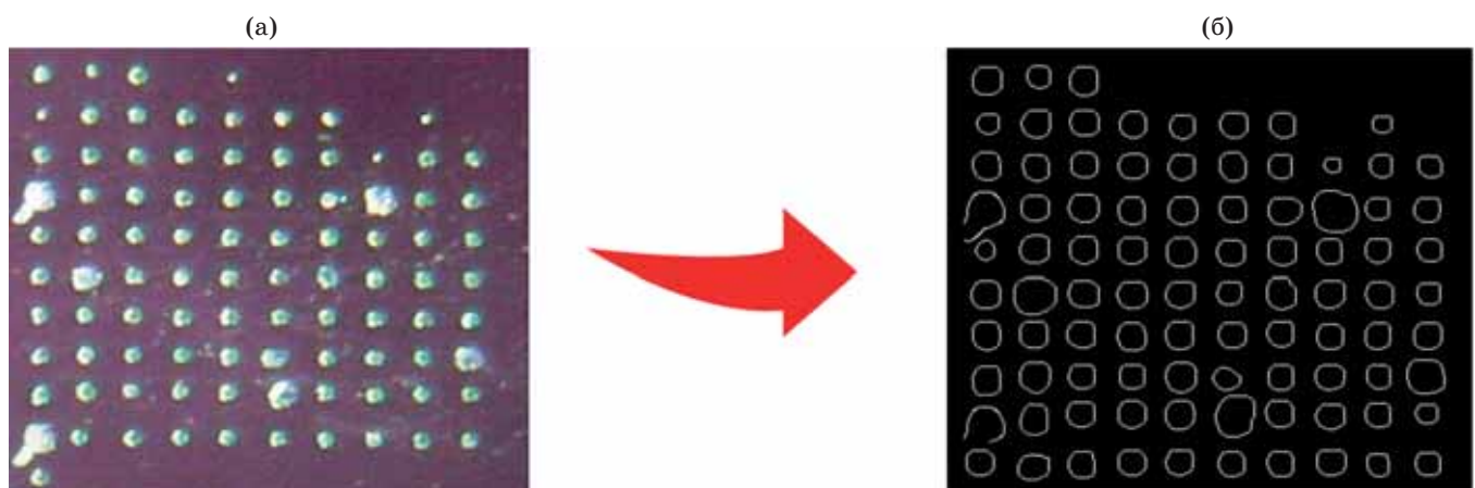
Рис. 4. Результат детектирования границ оператором Канни на изображении с массивом лазерно-индуцированных разрушений на поверхности оптического элемента (а — исходное изображение образца в отраженном свете, б — контуры Канни).
