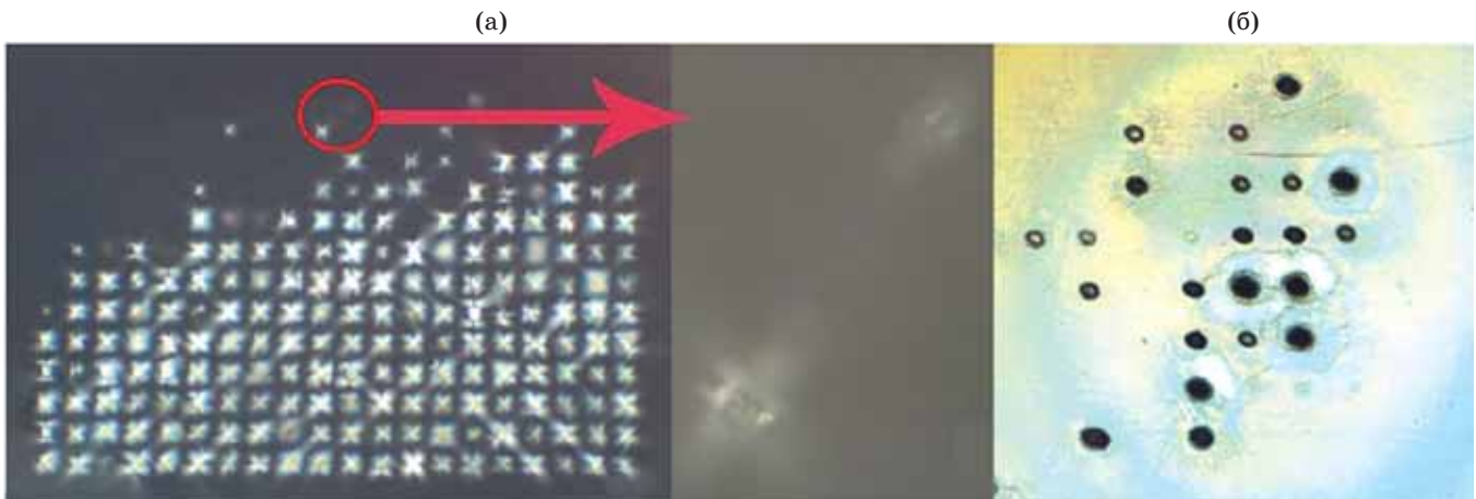
Рис. 1. Изображения полей сканирования. а — объемная дифракционная решетка (брэгговская решетка) в фототермофрактивном стекле, б — многослойное диэлектрическое покрытие \text{HfO}_2/\text{SiO}_2 на поглощающей подложке из карбида кремния.
